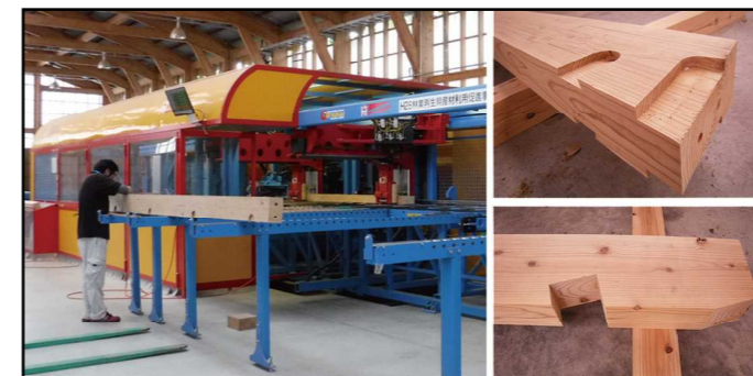
弊社プレカット工場・万能プレカット加工機
