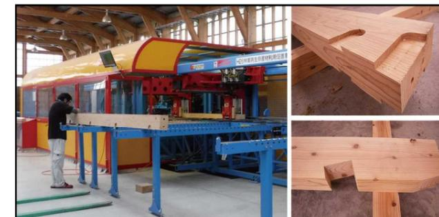
プレカット加工機にて、木材を切出します。
