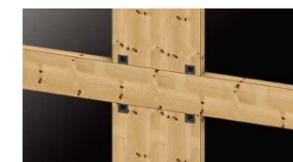
上下の接合は拡張樹脂アンカー工法を貫通させて使用します。
