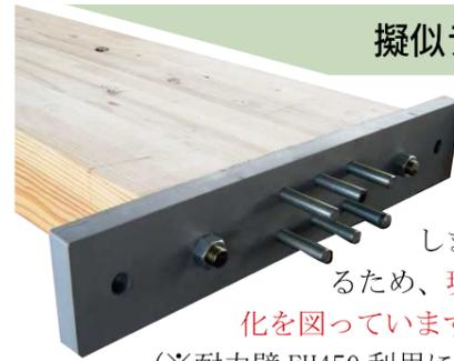
幅450mmの集成材柱脚部に高い引張強度を誇る拡張樹脂アンカー工法で接合することにより水平力に抵抗します。また、通常拡張樹脂アンカー工法は樹脂の注入作業を必要としますが、耐力壁 EH450 は集成材と接合具を取り付けた状態で出荷するため、現場での樹脂注入作業は必要なく高耐力でありながら建て方の効率化を図っています。
